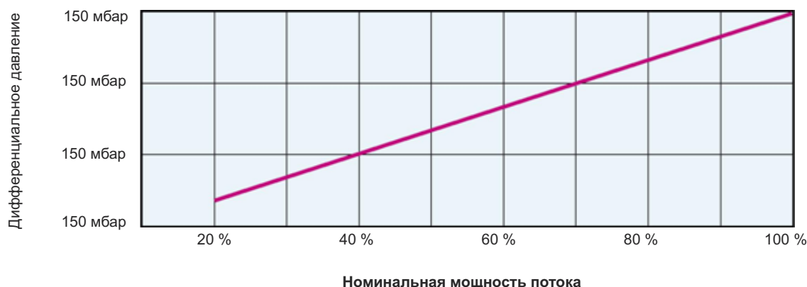
Дифференциальное давление на элементе фильтра А, включая корпус фильтра, при абсолютном давлении 8 бар
